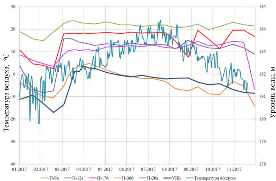
Рис. 2. Динамика уровней воды в пьезометрах на гребне плотины Васильевской, УВБ и температуры воздуха за 2017 г.
