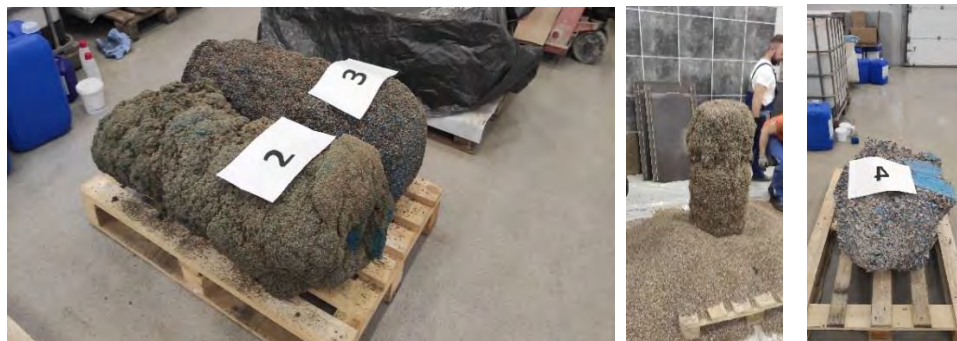
Рис. 6. Сформированные колонны в результате нагнетания гидрогеля с вязкостью более 8 мПа·с
