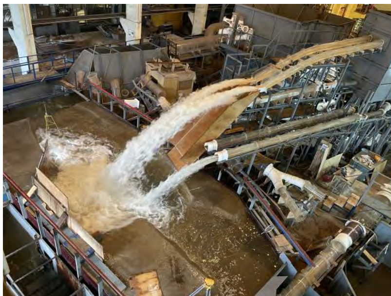
Рис. 8. Общий вид на отброс струи и режим течения в НБ при пропуске суммарного расхода 7350 м 3 /с через 1 ветку строительного туннеля СТ5 (СТ5-А), 1 ветку эксплуатационного туннеля ТВВУ1 и поверхностный водосброс ТВП
