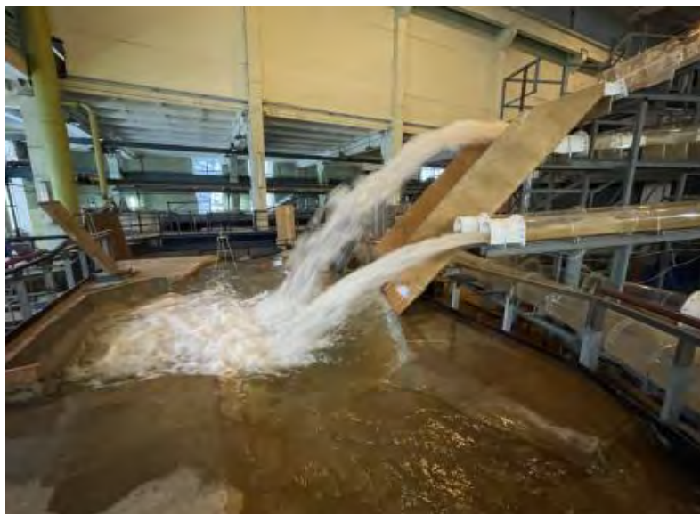
Рис. 7. Общий вид на отброс струи и режим течения в НБ при пропуске суммарного расхода 4300 м 3 /с через 1 ветку строительного туннеля СТ4 и 1 ветку строительного туннеля СТ5 (СТ5-А)
