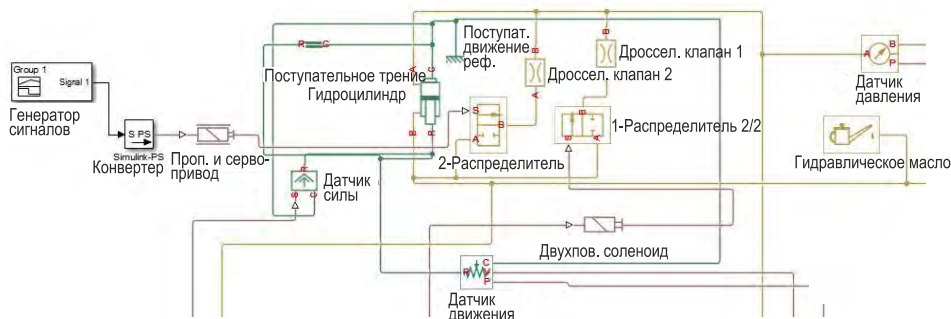
Рис. 8. Общая математическая модель (базовый сегмент) движения затвора – опускание под воздействием собственного веса
