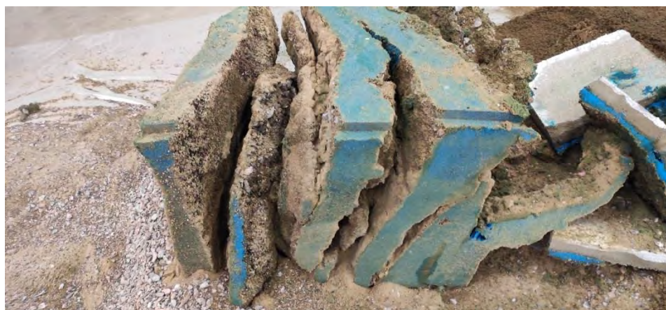
Рис. 5. Результат пропитки микс-песка гидрогелем с вязкостью более 8 мПа·с
