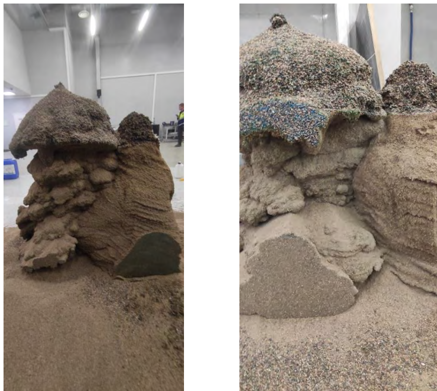
Рис. 8. Контактная зона колонн, образовавшаяся при пропитке гидрогелем с вязкостью 7 мПа·с на макете № 13
