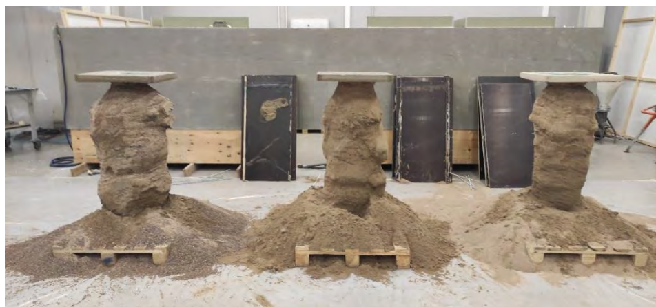
Рис. 7. Сформированные колонны под воздействием гидрогеля вязкостью 3–7 мПа·с
