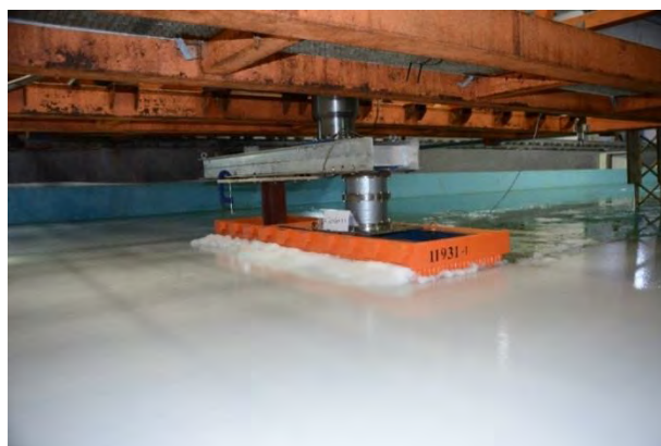
Рис. 4. Взаимодействие модели с вертикальной стенкой со льдом в ледовом бассейне
